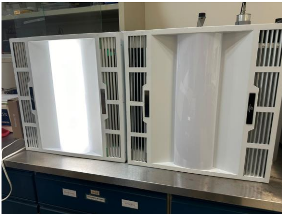
Figura 5.- Equipos para desinfección fotocatalítica que serán utilizados para las pruebas en entorno real, a realizar en un Hospital.
